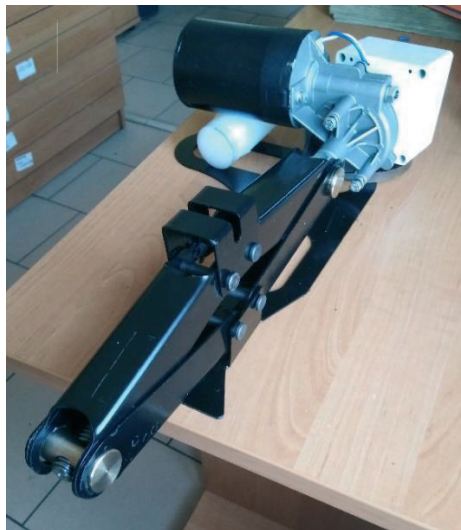
Rys. 4. Rzeczywisty podnośnik po montażu elementów
