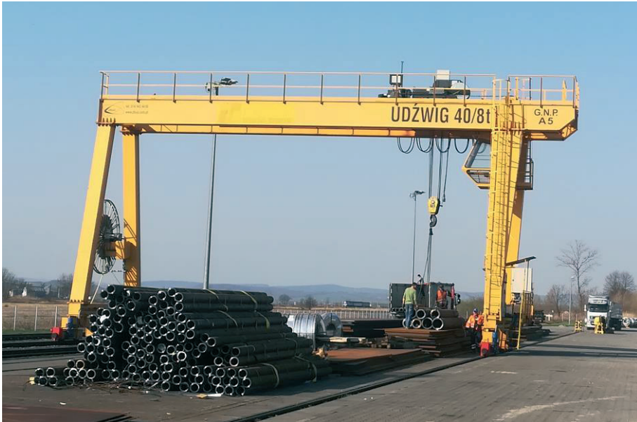
Rys. 5. Suwnica bramowa o nośności 40 ton
