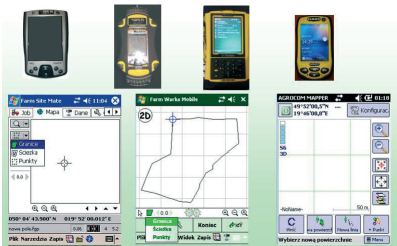
Rys. 9. Przykład komputerów polowych z odbiornikiem GNSS i programami do pomiaru powierzchni i zaznaczania punktów pomiaru
