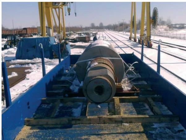
Rys. 13. Sposób zabezpieczenia ładunku pomocy kantówek i pasów
