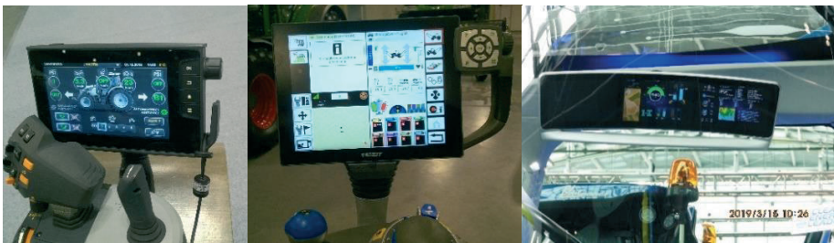
Rys. 2. Urządzenia sygnalizacyjne w ciągnikach rolniczych: a) Valtra, b) Fendt, c) New Holland
