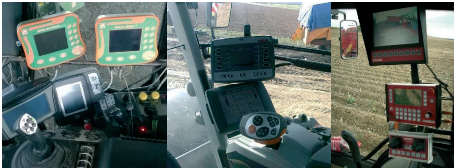
Rys. 3. Interfejsy operatorskie maszyn rolniczych: a) Fastrac, b) Claas XERION oraz c) Kombajn Grimme
