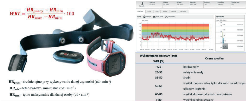
Rys. 7. Urządzenie do pomiaru liczby uderzeń serca oraz sposób oceny wysiłku fizycznego na podstawie wskaźnika rezerwy tętna
