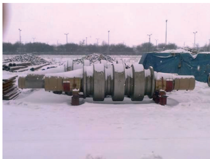
Rys.9 Przykładowe zdjęcia wałków roboczych: a) wałek o długości 5,07 m; b) wałek roboczy o długości 5,48 m
