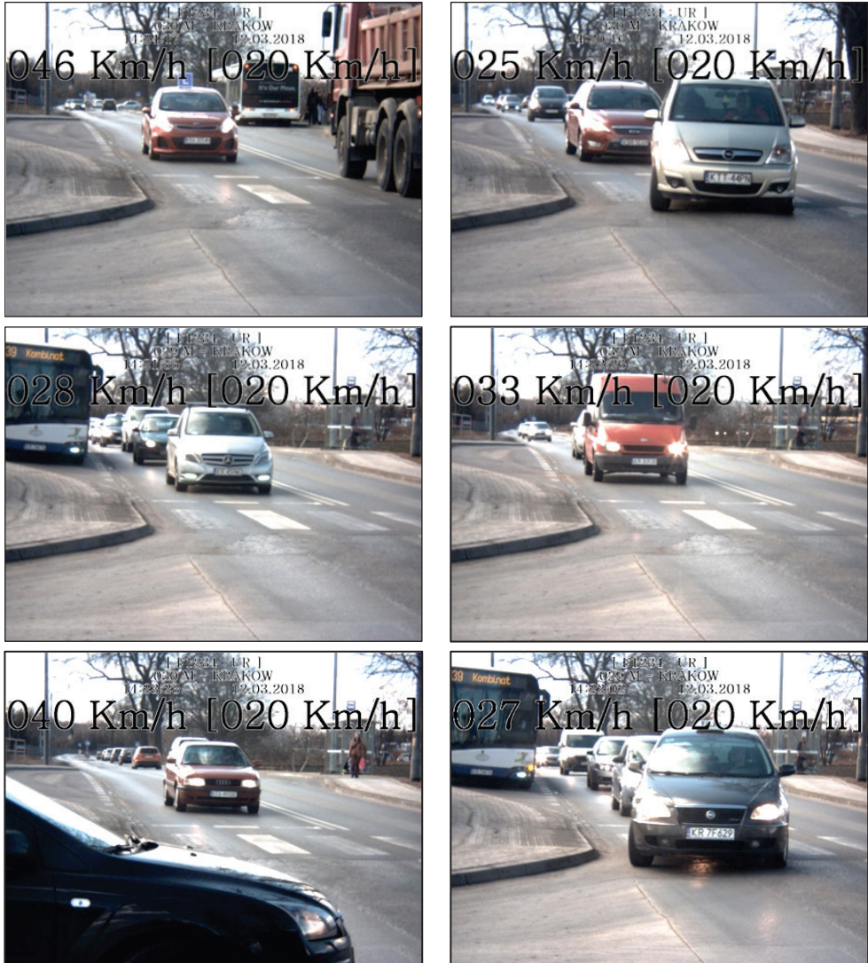
Rys. 12. Pomiar prędkości jazdy pojazdów z automatyczną archiwizacją danych
