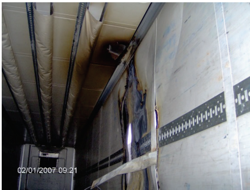
Rys. 1. Wnętrze naczepy po pożarze
