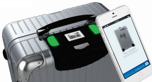
Rys. 13. Śledzenie bagażu na lotnisku z wykorzystaniem chipów RFID i sieci 2G
