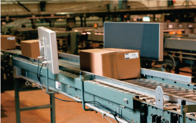
Rys. 8. Identyfikacja wyrobów na liniach produkcyjnych dzięki zastosowaniu transponderów RFID
