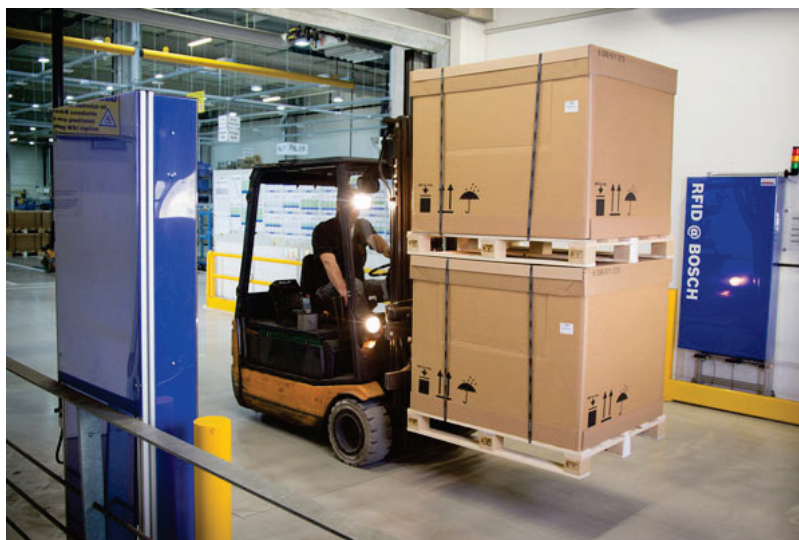
Rys. 7. Automatyczna identyfikacja i kontrola przepływu wyrobów w magazynach dzięki RFID
