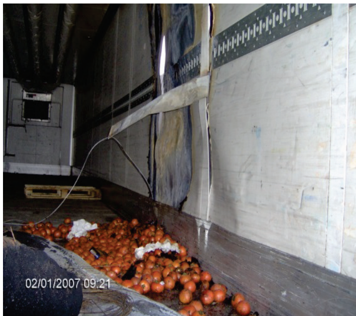
Rys. 5. Wnętrze naczepy ze spalonymi pomidorami
